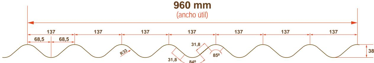
DATOS TÉCNICOS. Restricciones 979 kg/cm<sup>2</sup> f ≤ L/200
