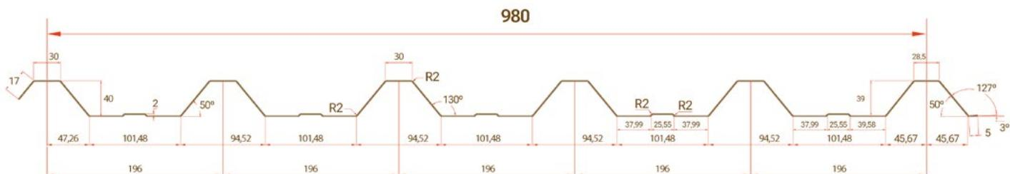
DATOS TÉCNICOS. Restricciones 979 kg/cm<sup>2</sup> f ≤ L/200
