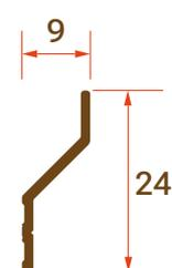
Utilizar en montajes con espacio insuficiente en el carril interior de la ventana.
